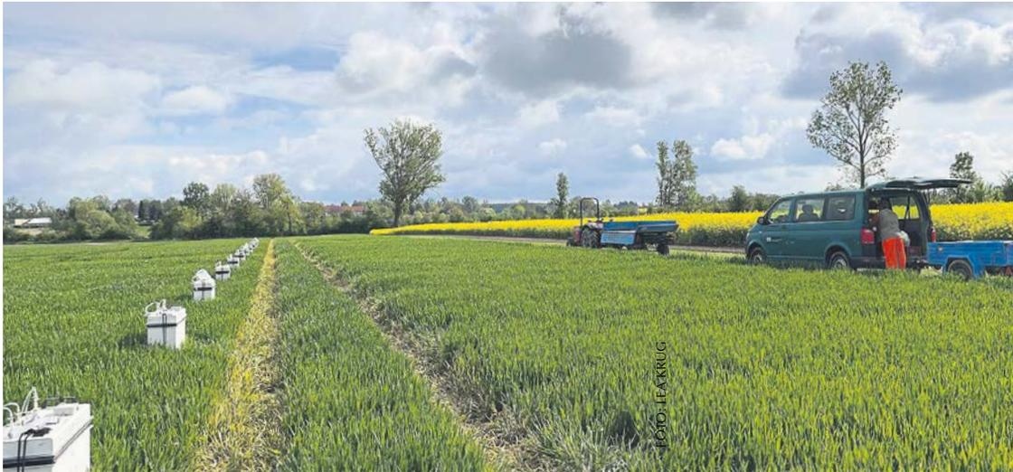
**Lachgasemissionen** werden über statische Stecksysteme gemessen. Dabei werden regelmäßig die abgedichteten Stecksysteme auf einen im Boden verankerten Rahmen gesetzt und luftdicht verschlossen. FOTO: MLU HALLE
