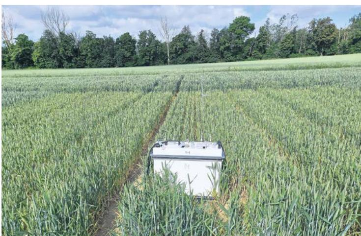
**Während dieser Messungen** werden alle 20 min Luftproben aus den Lachgashauben entnommen und zur Bestimmung der Lachgas-Konzentrationen in einem Gaschromatographen analysiert. FOTO: MLU HALLE
