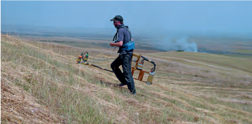
Abb. 27: Nazarlebi: Magnetometerprospektion mit dem handgetragenen Cäsium-Magnetometer Smartmag SM4-G Special in der Duo-Sensor-Konfiguration (Foto J. Fassbinder).
